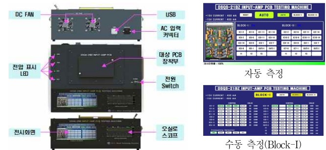
그림 5. 구현된 전치증폭 회로기판 검사장비 및 전시화면 구성도
